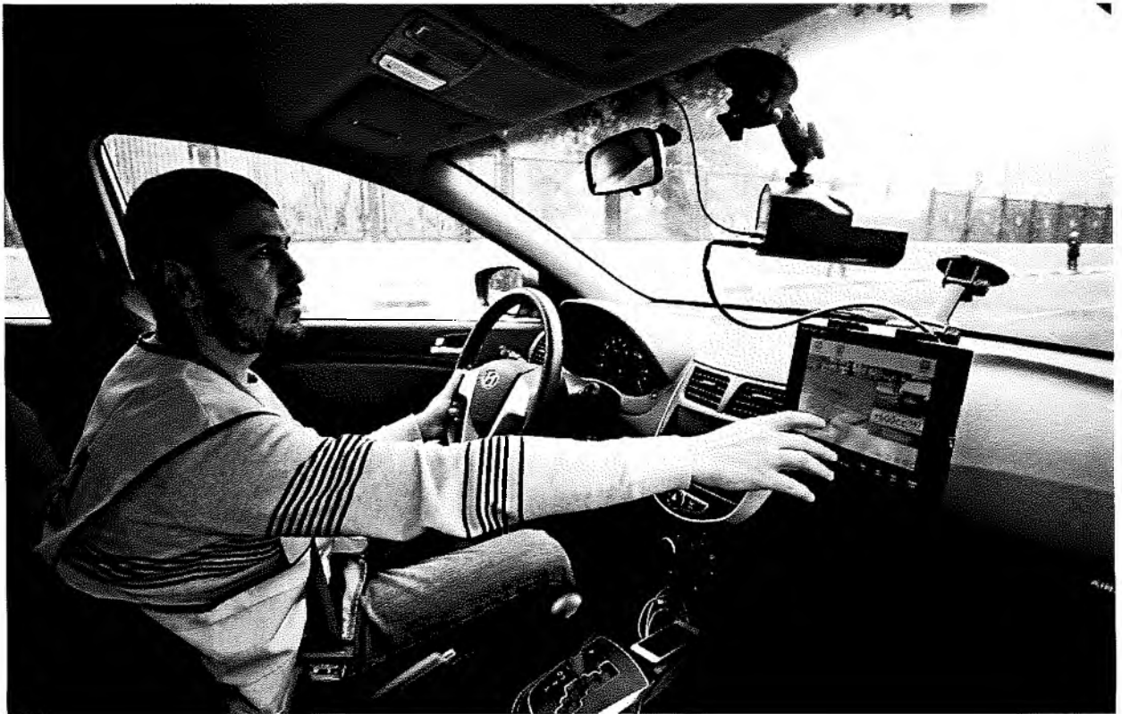
Рис. 68. Оборудование автомобиля «паркон»: камера и компьютер для распознавания регистрационных знаков
