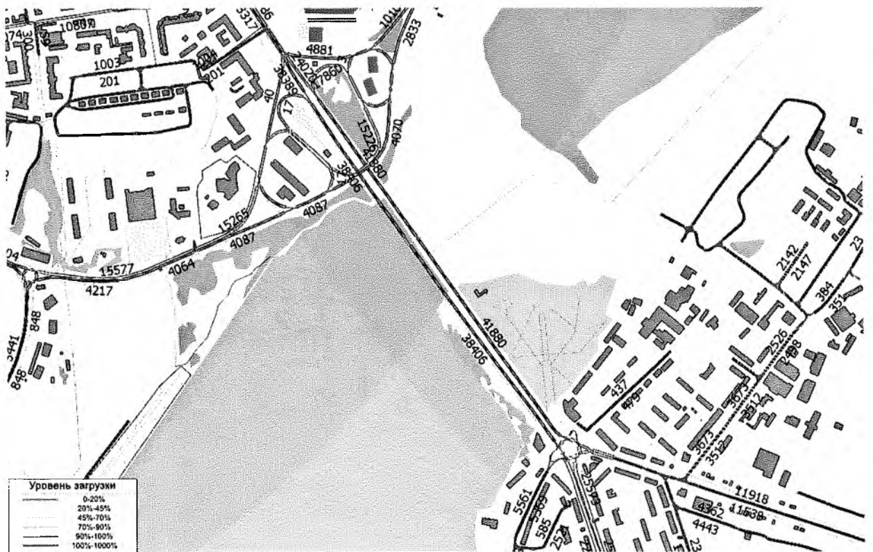
Рис. 25. Краткосрочный прогноз уровня загрузки Петровского моста (инерционный сценарий с учетом завершения реконструкции)
